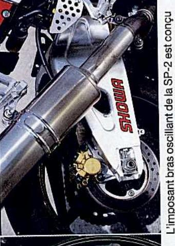
L'imposant bras oscillant de la SP-2 est conçu pour absorber bien plus que les 106 ch annoncés pour la version française. Entièrement réalisée en aluminium, il est bien sûr très rigide, mais en cas de gamelle on peut douter de sa capacité à encadrer le pot d'échappement vu sa faible épaisseur.
