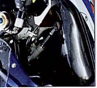
Contrairement aux trois twins qui utilisent des embrayages hydrauliques, les quatre-cylindres de cet essai font appel à des câbles. On peut ainsi mieux doser et éventuellement faire patiner... Notez le système de frein de la molette de réglage : simple et efficace !
