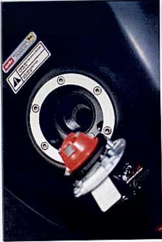
Dans l'ensemble, le remplissage du réservoir, acte on ne peut plus fréquent avec des sportives, n'est pas trop galère... sauf sur l'Aprilia ! L'orifice de remplissage est petit, le réservoir est haut et pour corser le tout ça roule pas malen fin de remplissage.
