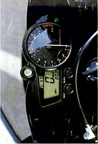
Sur la R1, on retrouve côté affichage digital le compteur kilométrique (avec décompte des km après passage en réserve), deux trips partiels, l'heure, la température d'eau et la vitesse instantanée. La petite lampe blanche s'allume lorsqu'un régime, programmable à l'avance, est atteint.
