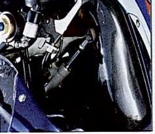
Contrairement aux trois twins qui utilisent des embrayages hydrauliques, les quatre-cylindres de cet essai font appel à des câbles. On peut ainsi mieux doser et éventuellement faire patiner... Notez le système de frein de la molette de réglage : simple et efficace !
