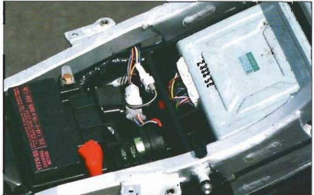
Le boîtier électronique de l'injection est localisé juste derrière la batterie, dont le support accueille le capteur de renversement. Le tout se trouve sur le treillis arrière du cadre.
