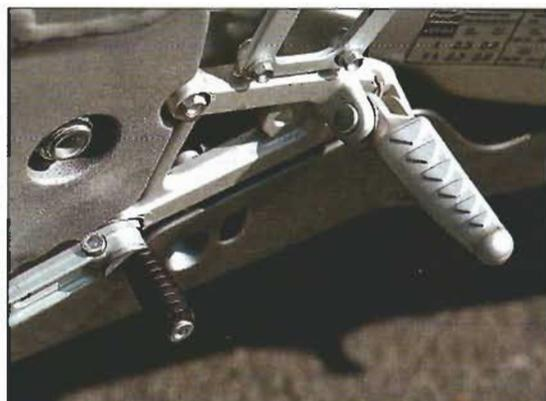
▲ *La position des commandes est réglable au niveau des excentriques du sélecteur et de la pédale de frein arrière. L'ergonomie générale de la RSV est excellente.*
