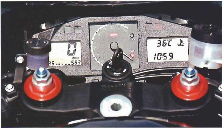
▲ **Tableau de bord très complet avec compte-tours électronique analogique, compteur de vitesse, température d'eau et montre digitale. Le régime de zone rouge est réglable et allume une diode. L'ordinateur de bord permet d'enregistrer d'autres infos : temps chrono, vitesse maxi, etc.**
