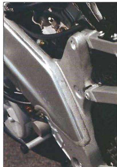
▲ Superbe soudure sur le cadre entre un caisson de tôle d'alu et la partie de fonderie d'aluminium arrière.
