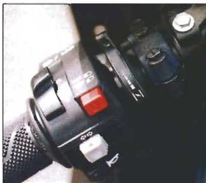
▲ *Pour le démarrage à froid, la RSV 1000 dispose d'un accélérateur manuel qui assure un ralenti accéléré comme sur la Suzuki TL.*
