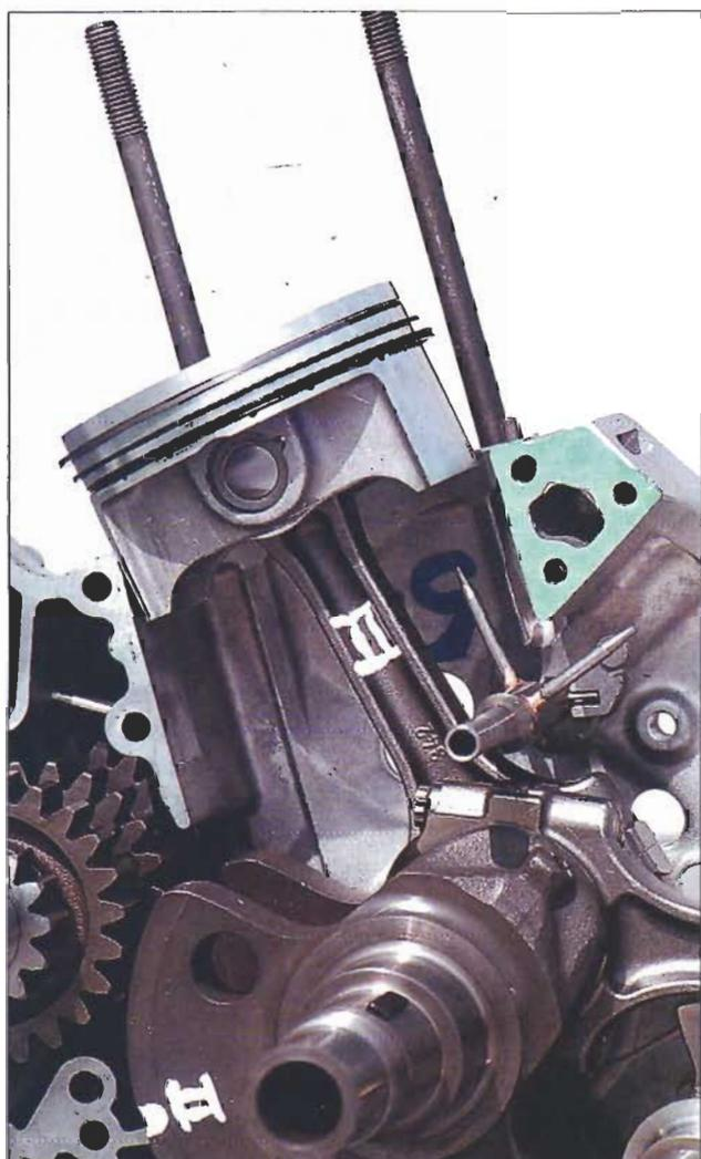
▲ Voici comment les pistons sont refroidis et lubrifiés, grâce aux deux petits conduits éfilés qui font gicler l'huile directement en dessous de la calotte de piston. Ce dispositif est en quelque sorte une amélioration du système qu'utilise Suzuki sur ses GSX-R.
