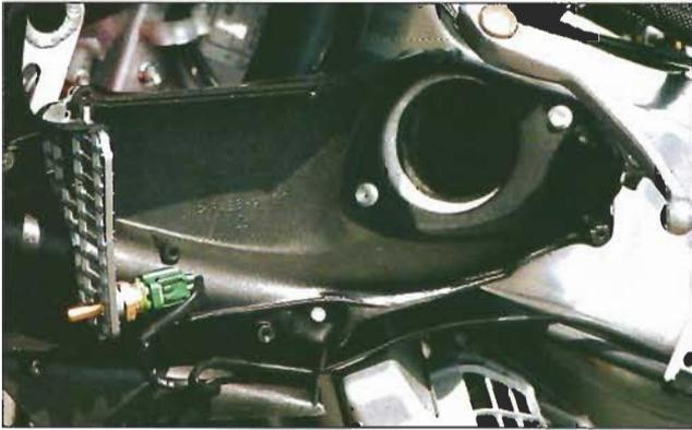
Sur cette vue, on peut voir le capteur de température d'air admis, qui est fixé sur la grille de la tubulure d'admission gauche. Ensuite l'air traverse le cadre pour atteindre la boîte à air.
