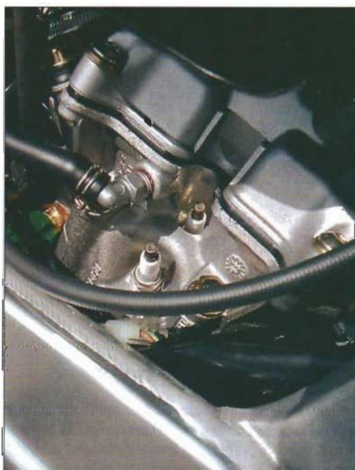
L'allumage de la RSV 1000 comporte quatre bougies et deux bobines. Ici, les deux bougies du cylindre arrière, positionnées parallèlement à 25°.
