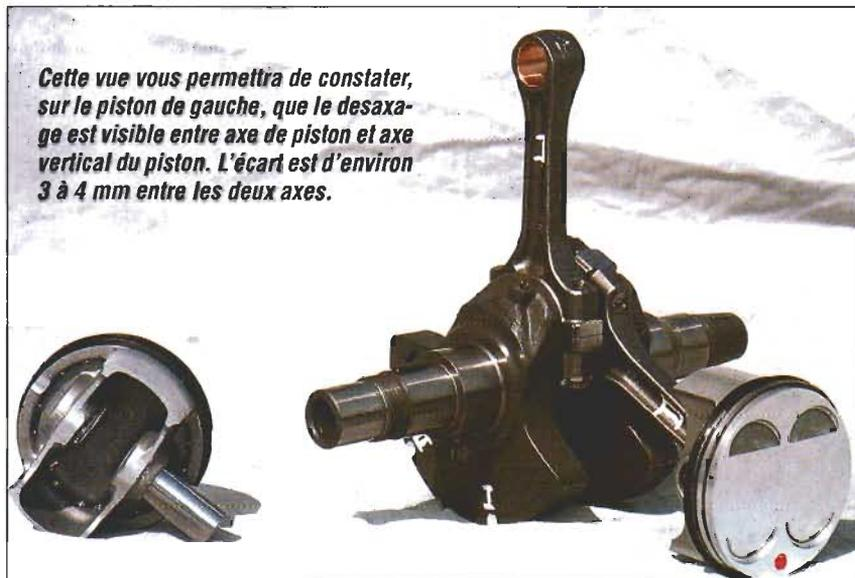
*Cette vue vous permettra de constater, sur le piston de gauche, que le desaxage est visible entre axe de piston et axe vertical du piston. L'écart est d'environ 3 à 4 mm entre les deux axes.*
