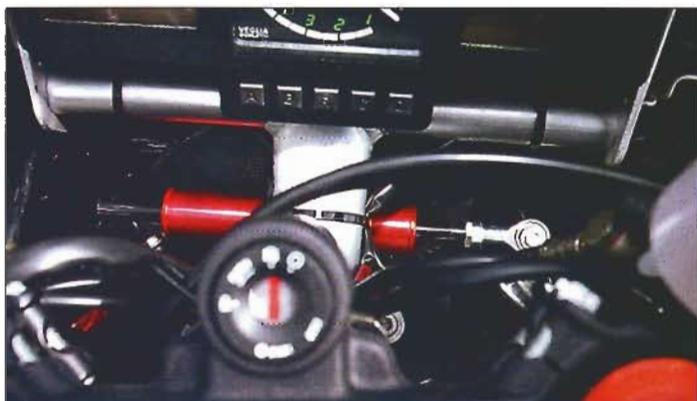
▲ *Un amortisseur de direction a été installé sous l'instrumentation, perpendiculairement à la moto. Il limite les guidonnages car la RSV déleste facilement lors de fortes accélérations ou remise des gaz sur les premiers rapports.*
