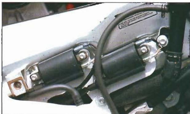
Les bobines sont montées sur les poutres du cadre périmétrique (2 de chaque côté). Il y a une bobine par bougie, assurant ainsi l'allumage même si un des éléments est sujet au disfonctionnement.
